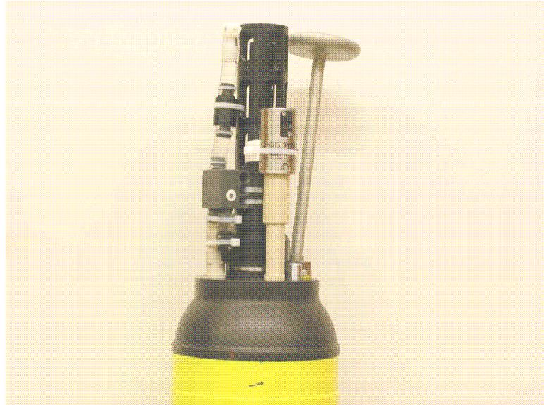
Figure 2: Placement de la tête de l'ISUS sur la tige supérieure d'un flotteur-profileur APEX
