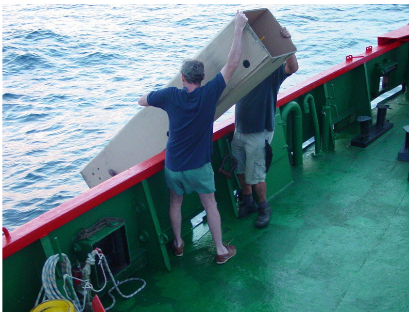
Déploiement d'un Provor par caisse perdable en Méditerranée lors de la campagne MFSTEP
