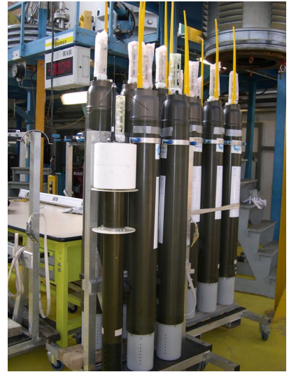
PNG et Provor en essais caisson
