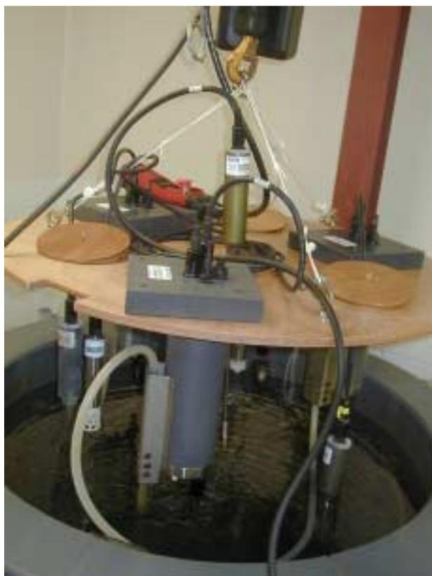
*Thermosalinomètre Sea Bird en cours d'étalonnage au SHOM*
