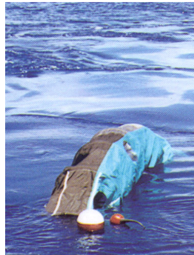
Mise à l'eau d'une bouée SVP et son ancre flottante
