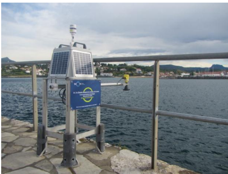
Figure 25 : Le MCN déployable développé par le Shom : autonome, équipé d'un radar et de panneaux solaires. Se transporte dans un coffre de voiture et s'installe en une heure.
