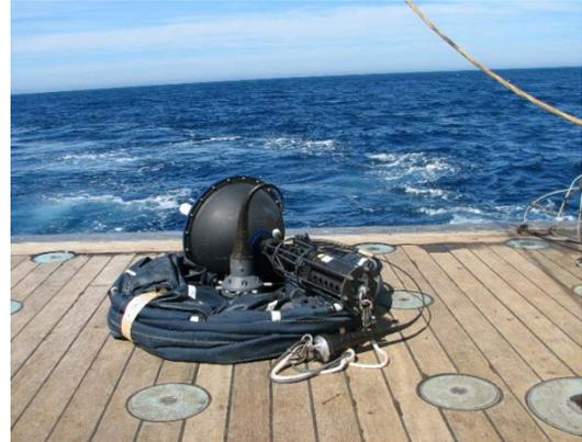
Figure 9 : Bouée SVP-BU (Pression, salinité) sur le pont, avant sa mise à l'eau
