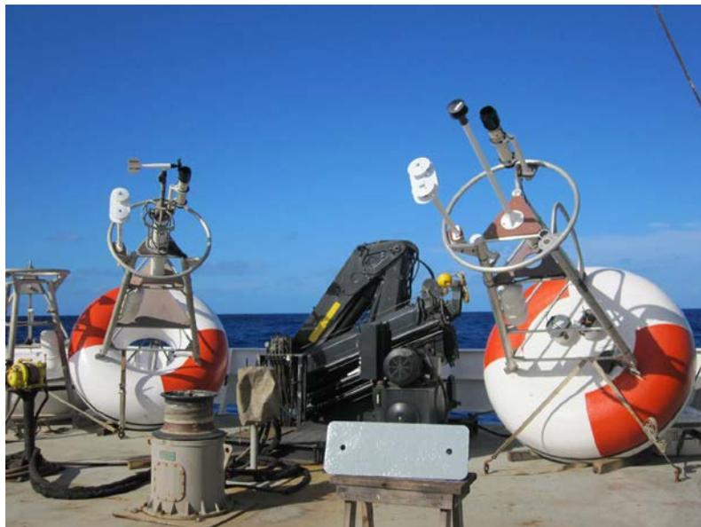
Figure 6 : Bouée ATLAS (à gauche) utilisée depuis le début de PIRATA, et bouée T-FLEX (à droite) remplaçant progressivement les ATLAS à partir de 2016.
