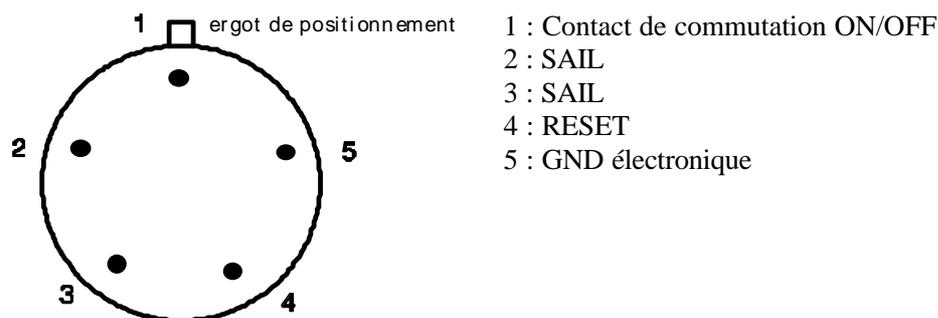
fig. 3: câblage du connecteur SAIL.
