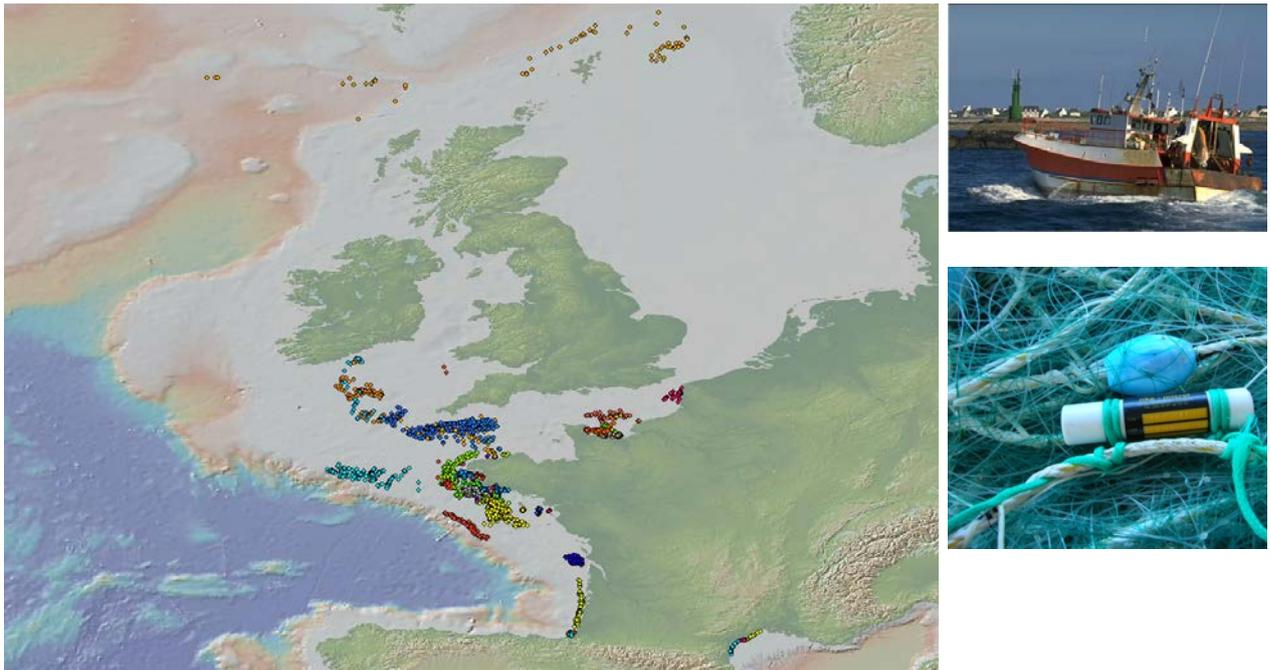
*Recopesca en 2011 : près de 5000 profils verticaux effectués transmis en temps réel à partir de 47 capteurs déployés sur des bateaux de pêche.*
