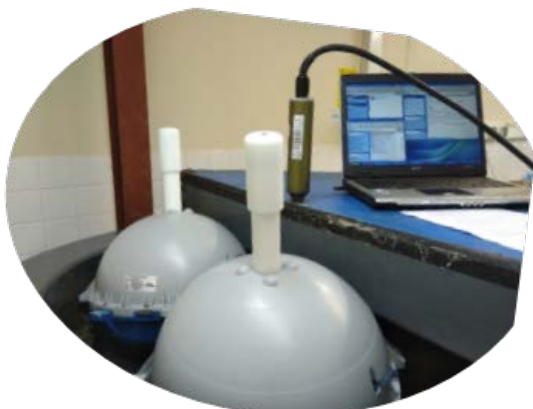
Vérification de l'étalonnage de 2 bouées SVP-BRST dans le laboratoire de métrologie du SHOM, avant leur validation. Les bouées sont immergées dans un bac d'étalonnage rempli d'eau de mer.
